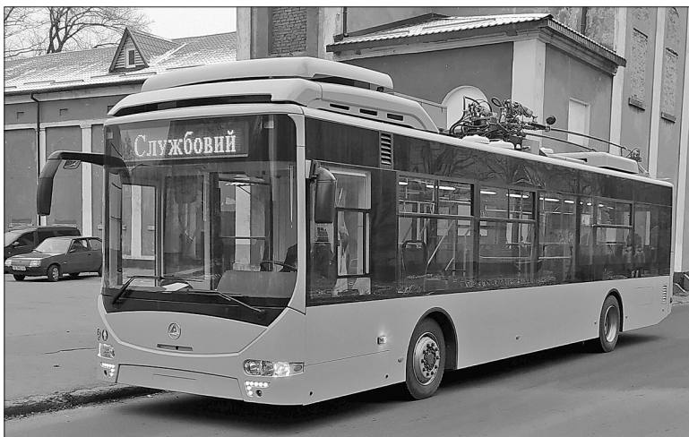
Не менш цікавий і тролейбус великого класу Т12220, що має запас автономного ходу 20 км
