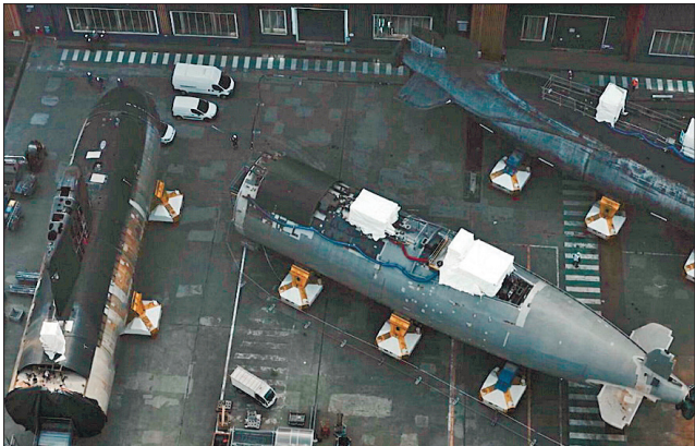
Передню частину човна та задню зварять в одне ціле
